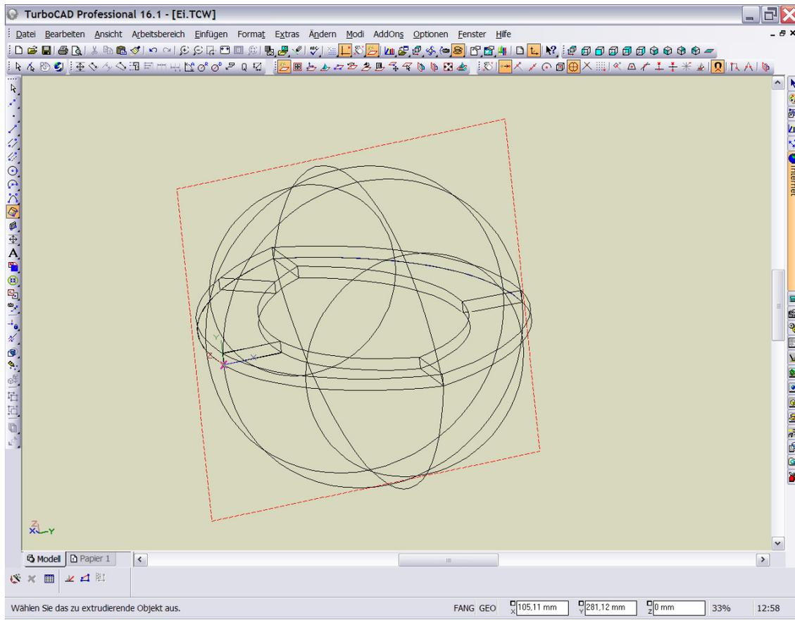
Zuerst Arbeitsebene in die Mitte, dann Profil an die gewünschte Stelle zeichnen und mit EXTRUSION die Nut erstellen
