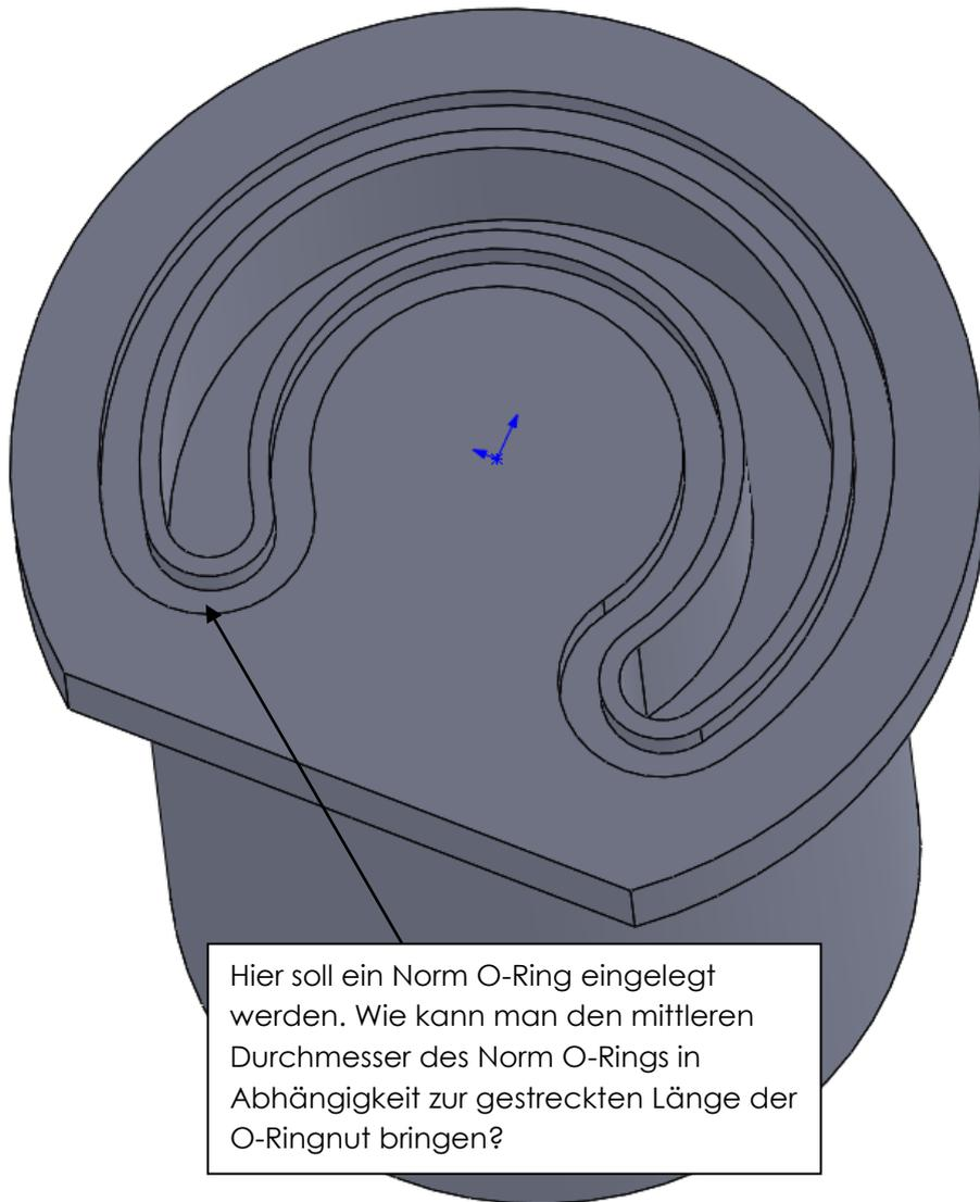
Hier soll ein Norm O-Ring eingelegt werden. Wie kann man den mittleren Durchmesser des Norm O-Rings in Abhängigkeit zur gestreckten Länge der O-Ringnut bringen?
