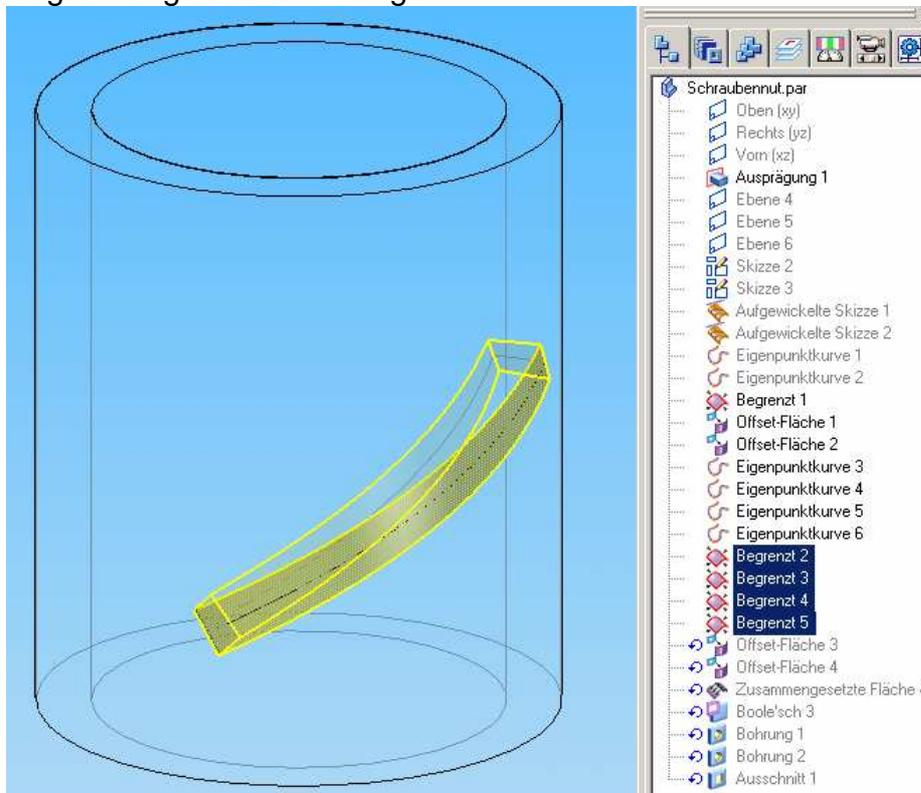
Offsetflächen erzeugen, damit keine tangentielle Berührung mit Zylinder entsteht.
