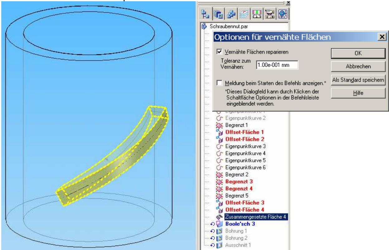
Boole'sche Operation an den Enden Bohrungen einfügen. Fertig
