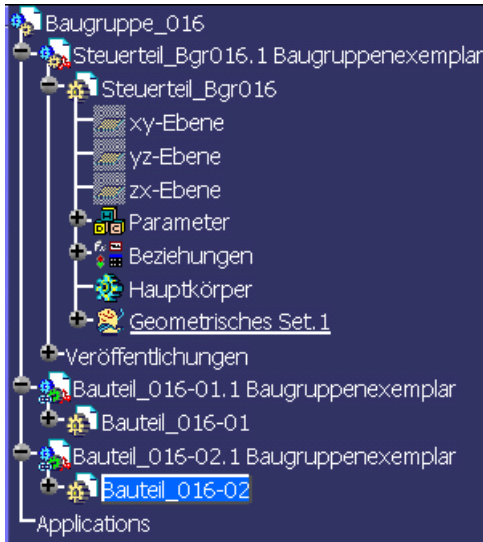
Baugruppenstruktur mit Steuerteil
