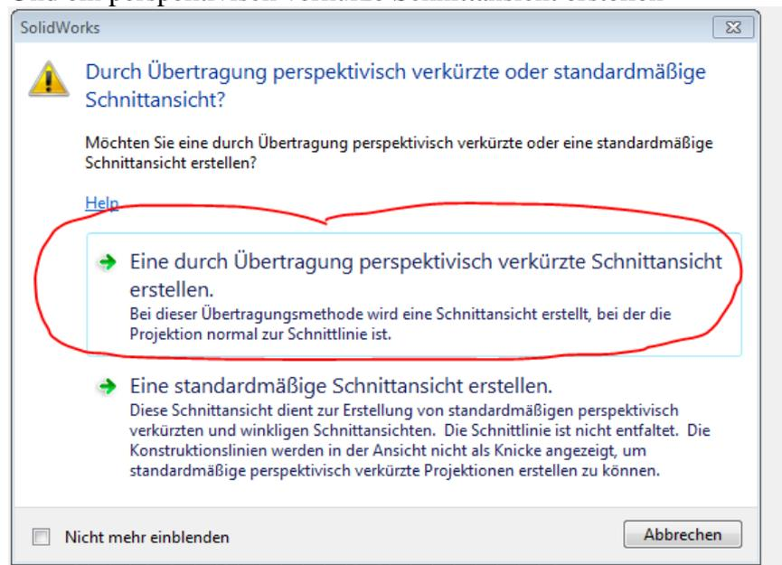
Schnitt B-B ist ein umgelenkter Schnitt, den verwendet man um Schnitte an Wellen, Flanschen darzustellen
