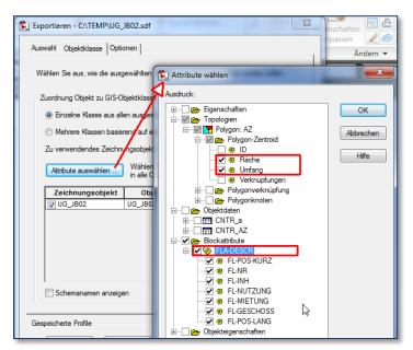
• Weiters ist in diesem Dialog noch zu definieren, welcher Geometrietyp im SDF zugelassen ist. Das stellen wir bei einer Flächentopologie auf *Polygon*.
