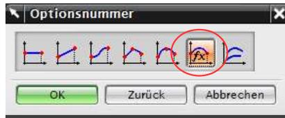
Im Menü *Optionsnummer* (*Law Function*) muss zunächst die Funktion *Durch Gleichung* (*By Equation*) gewählt werden.
