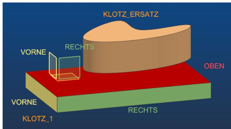
In diesem Beispiel wurden beim Ersetzen einer Komponente die Zwangsbedingungen automatisch von Flächen auf Bezugsebenen übertragen.
