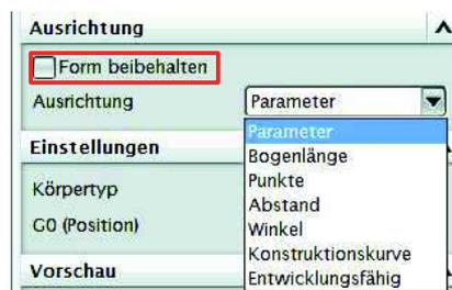
Die *Parameter*-Methode ist anzuwenden, wenn beide Kurvenzüge die gleiche Anzahl von Objekten aufweisen. Parameter heißt hierbei, dass immer die korrespondierenden Kurven verbunden werden.
