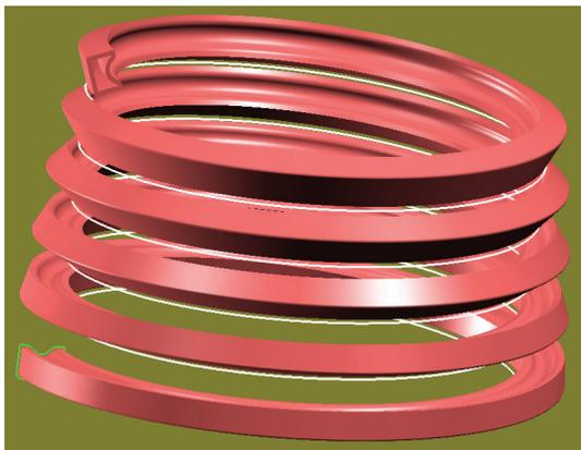
Die eben beschriebene Funktion, einen nicht kreisförmigen Querschnitt entlang einer Spirale zu verschieben und dabei eine technisch sinnvolle Spiralfeder zu bekommen, ist eines der häufigsten Freiformprobleme, das in UNIGRAPHICS/NX-Foren oder an der UNIGRAPHICS-Hotline nachgefragt wird. Eine saubere Möglichkeit ist eigentlich nur mit Hilfe der nachfolgenden Freiformflächenfunktion möglich.
