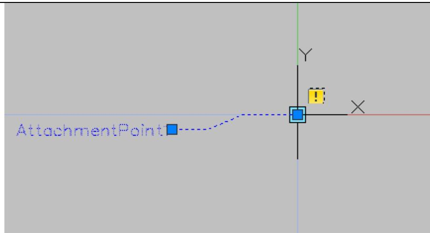
Anlegen eines Blocks mit einer senkrechten Linie sowie einem AttachmentPoint.
