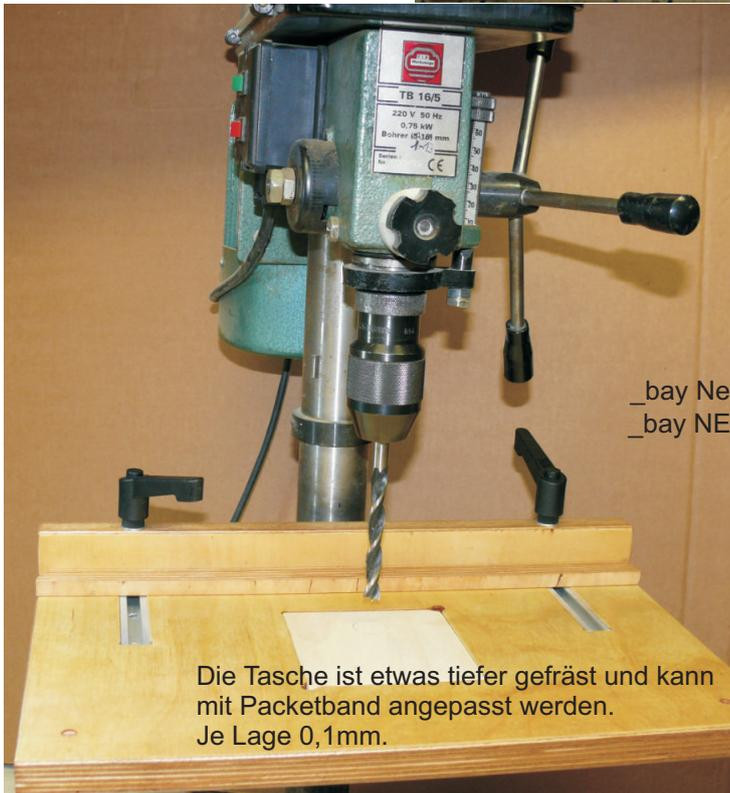
Die Tasche ist etwas tiefer gefräst und kann mit Packetband angepasst werden. Je Lage 0,1mm.
