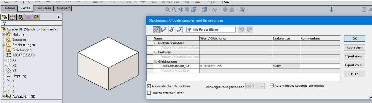
Es kann eine Gleichung zwischen zwei Maße auch im Gleichungseditor erstellt werden. Dazu Gleichungseditor öffnen > Zelle in Spalte Name anklicken > Maß am Modell anklicken (Maßbenennung wird in die Zelle übertragen) > Zelle in Spalte Wert / Gleichung anklicken > Maß am Modell anklicken > Enter und OK.
