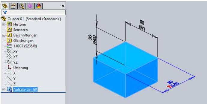
Im Gleichungseditor unter - Extras > Gleichungen - ist diese Gleichung gelistet und bearbeitbar.
