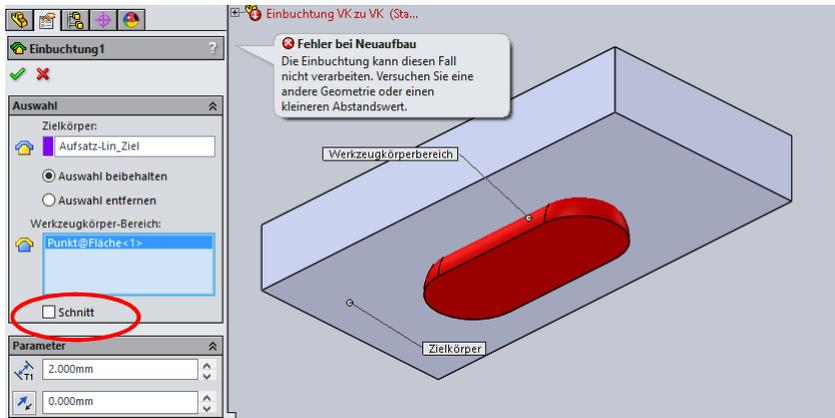
Zielkörper Volumen - Werkzeugkörper Volumen. Schnitt eingeschaltet.
