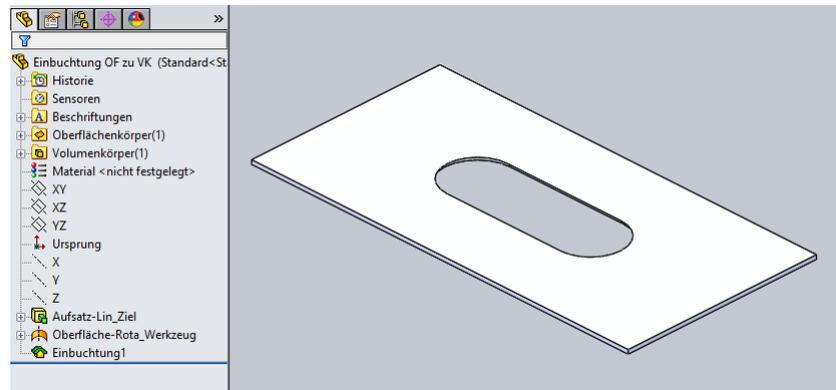
Zielkörper Volumen - Werkzeugkörper Oberfläche. Schnitt ausgeschaltet.
