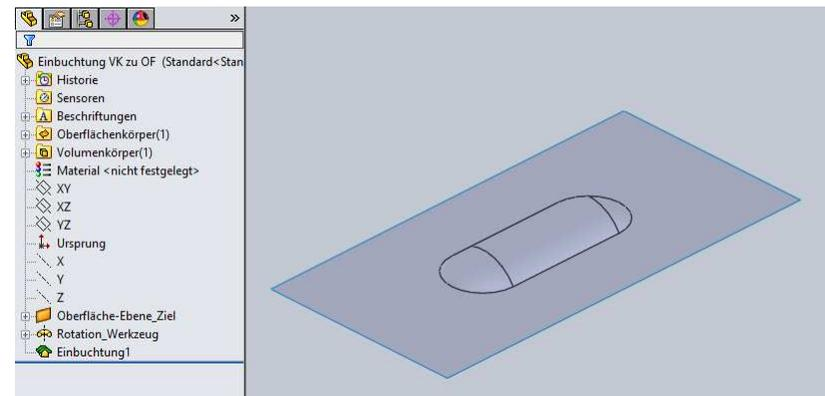
Zielkörper Oberfläche - Werkzeugkörper Volumen. Schnitt eingeschaltet.
