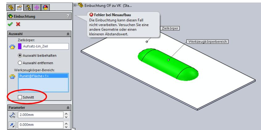
Zielkörper Oberfläche - Werkzeugkörper Volumen. Schnitt ausgeschaltet.
