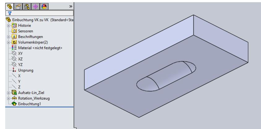
Zielkörper Volumen - Werkzeugkörper Volumen. Schnitt eingeschaltet.
