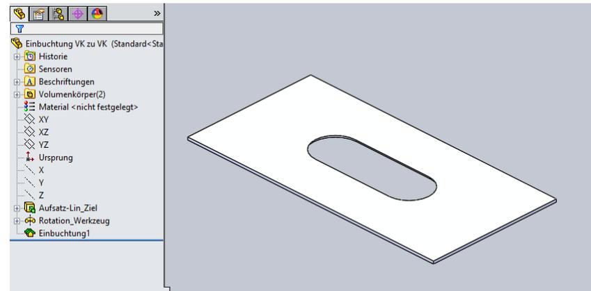
Zielkörper Volumen - Werkzeugkörper Oberfläche. Schnitt eingeschaltet.
