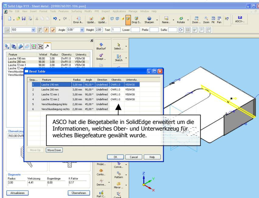
Werden die angezeigten Werte übernommen, werden die Biegefeatures im 3D-Modell in Bezug auf Radius und K-Faktor angepasst. Das 3D-Modell verändert sich. Jedes FlatPattern beruht somit also auf den den Werkzeugen angepassten, korrekten Daten. Gleichzeitig wird die Biegetabelle von SolidEdge zu dem Teil aktualisiert.
