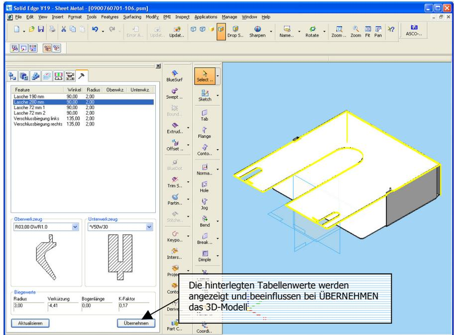
Nach der Auswahl der Werkzeuge, sind damit alle benötigten Werte: Material und Stärke/Dicke (aus dem Teil), OberWKZ, Prisma und Winkel (aus den Features) bekannt. Zu diesen Informationen werden jetzt aus einer hinterlegten Biegewertetabelle passend der Radius und der K-Faktor ausgelesen (oder ggf. über Tabellenstützwerte interpoliert).
